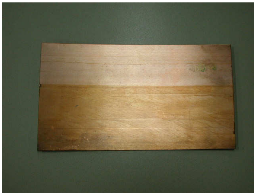
Figura 11. Mancha em aço-carbono revestido com cobre, proveniente de contaminação da água de lavagem por sólidos dissolvidos.
