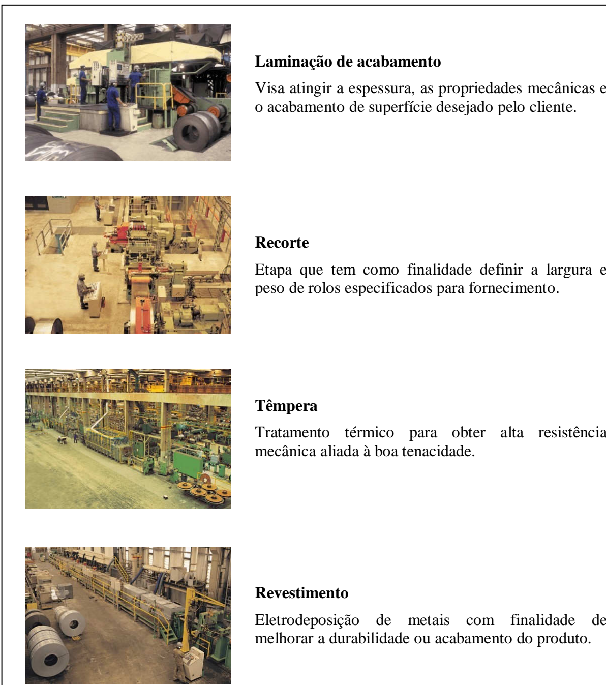
Figura 3. Principais etapas do processo de relaminação
