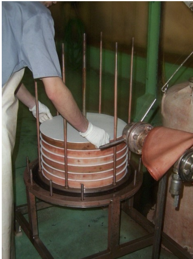
Fotografia 2. Filtro sparkler: montagem das placas de polietileno intercaladas com papéis porosos Fonte: O autor (2006)
