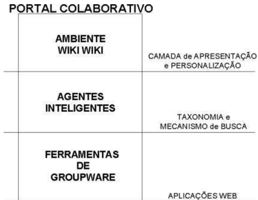
Figura 3: Divisão em camadas de um Portal Colaborativo, conforme proposto por Terra; Gordon (2002)
