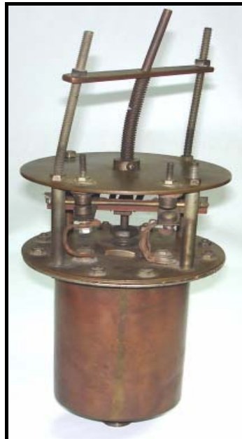
Figura 14 – Primeiro chuveiro elétrico automático fabricado pela Lorenzetti. (LORENZETTI (2005)).
