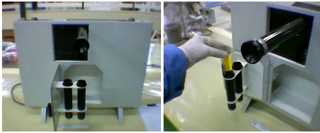
Foto 1 – Foto do Equipamento Lovibond utilizado no ensaio de branqueamento.
