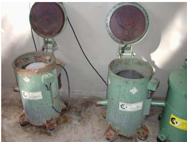
Figura 6 – Equipamento utilizado para secagem do produto.
