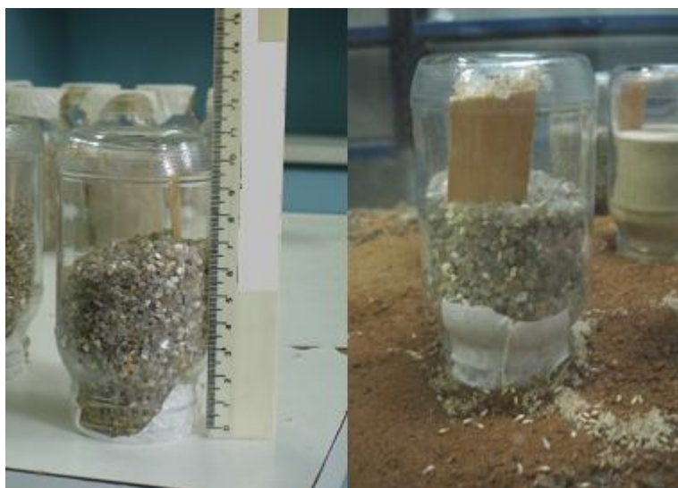
Foto 5 - Frascos de vidro com areia, lâmina de Pinus, e fita crepe, fotografados durante a montagem (A) e durante a realização do ensaio (B).
