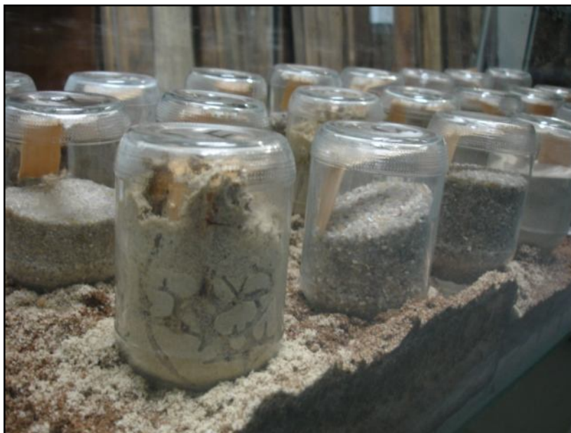
Foto 7 – Barreira de areia atravessada no frasco durante a realização do ensaio.
