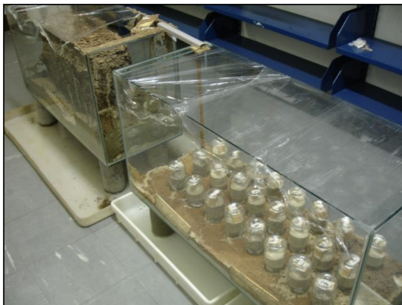
Foto 6 - Exposição dos frascos à colônia de cupins da espécie Coptotermes gestroi em laboratório.
